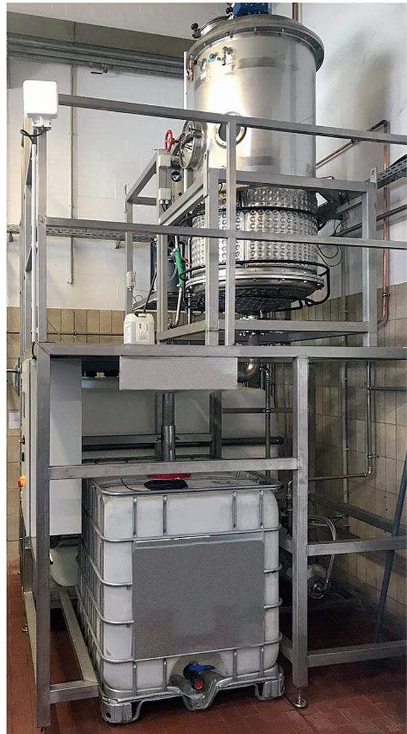
Abb. 3: Verdampfer erzeugen ein Konzentrat, das gereinigt wieder dem Elektrolyt zugefügt werden kann
